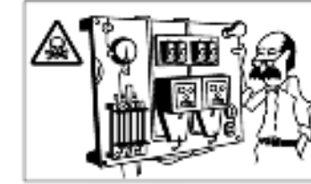
DEFECTES D'AÏLLAMENT EN MAQUINES EL QUE EL SISTEMA DE PROTECCIÓ SE TROBA EN MAL ESTAT.
